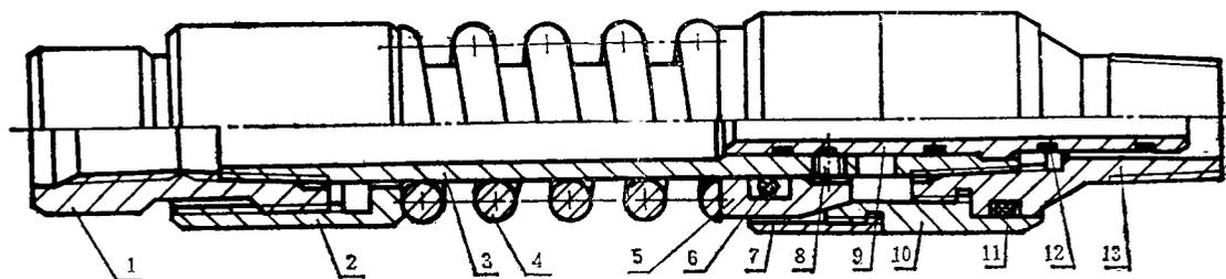
1—上接头；2—调节环；3—中心管；4—弹簧；5—阀；6、11、12—O型盘根；7—护罩；8—销钉；9—滑套；10—阀座；13—下接头
