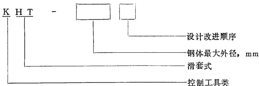
示例：KHT-114B喷砂器，表示为控制类井下工具，钢体最大外径为114mm，第2种滑套式喷砂器。
